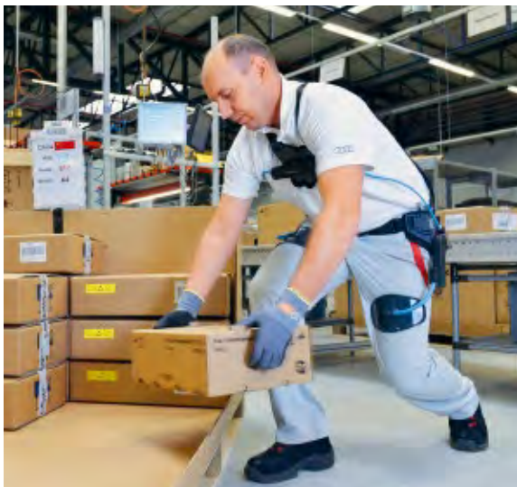
Als ergonomisches Hilfsmittel unterstützt ein Exoskelett beim Heben und Tragen, hier in der Completely-Knocked-Down-Logistik von Audi.
